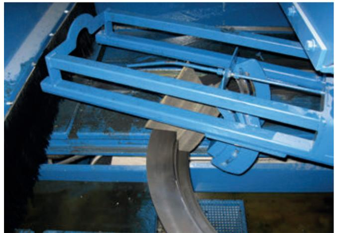
Смазка муфты при помощи губки без использования распылительного тумана
