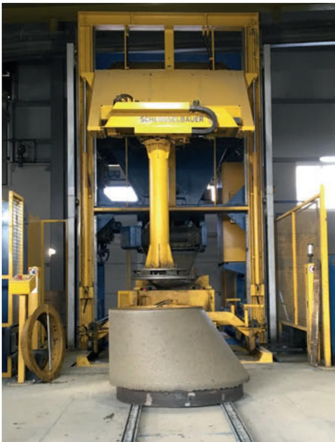
Производственная установка Magic компании Schlüsselbauer Technology
