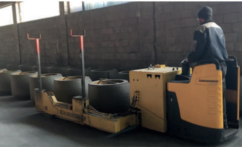
Изделие доставляется в зону выдержки на специальной транспортировочной тележке
